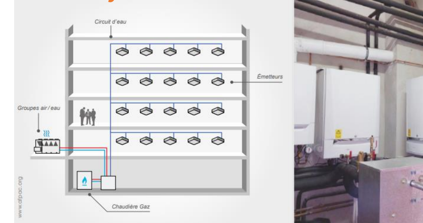
Hybridation de chaufferie
