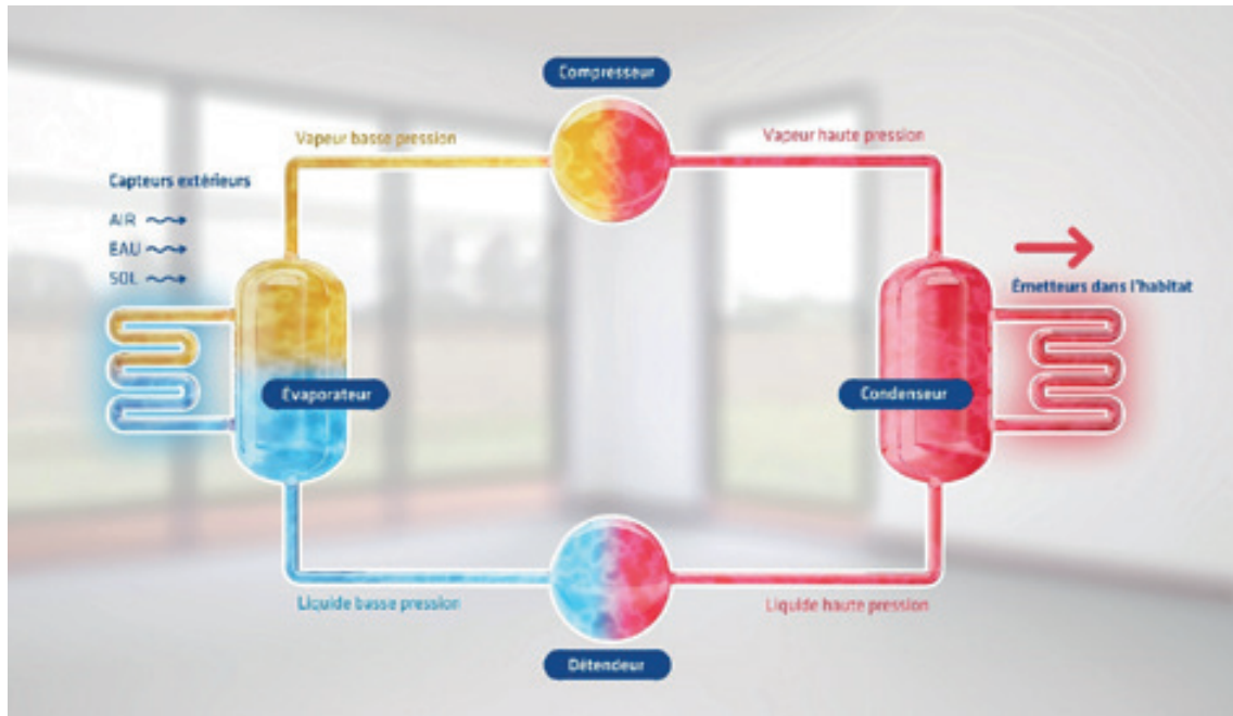
Figure 1. Le fonctionnement d'une PAC. Source : AFPAC
