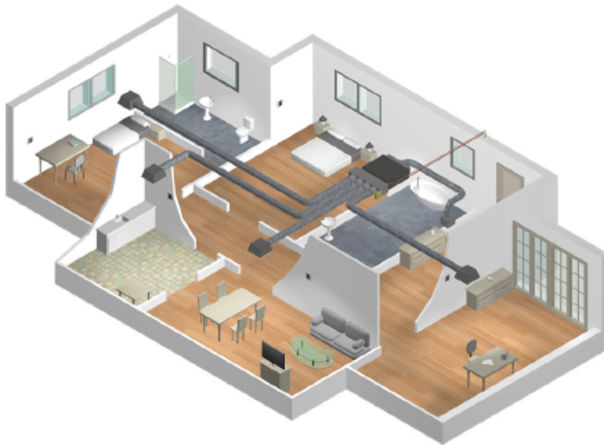
Figure 3 : Exemple d'utilisation d'une pompe à chaleur air extérieur/air intérieur en éléments séparés avec réseau aéraulique de distribution d'air multi-zones
